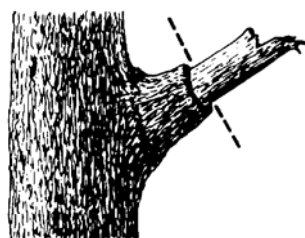
En una rama muerta con un collar de madera viva, el corte final se debe hacer fuera del borde más externo del collar.
